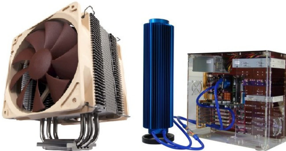
Illustration 7: « Ventirad » et Watercooling
